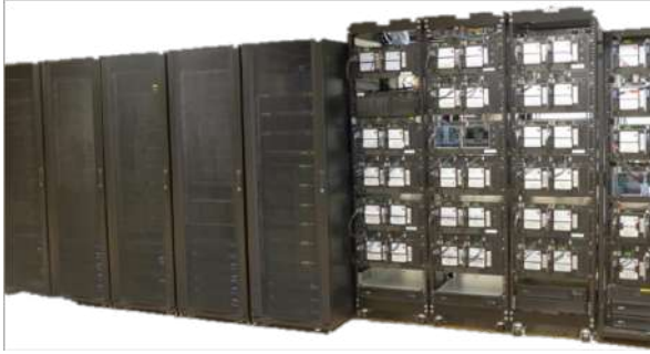
Figura 17: MIT é o famoso Massachusetts Institute of Technology e o MIT Correlator é um poderoso supercomputador que faz a correlação matemática bilhões de vezes por segundo entre os sinais dos pares de antenas que podem ser formados entre os 8 radiotelescópios do EHT . Crédito: Nancy Wolfe Kotary, MIT Haystack Observatory. Fonte: www.forbes.com/sites/tomcoughlin/2019/06/26/black-hole-data-processing-storage/#1d03ff69b5bca .
